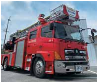
1,300ℓの水槽と自動薬液混合装置を搭載
