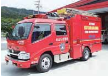
1,300ℓの水槽と自動薬液混合装置を搭載
